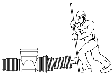
図7-31 リブパイプの挿入
