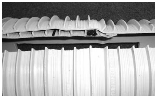
写 4-1 供試体断面状況
