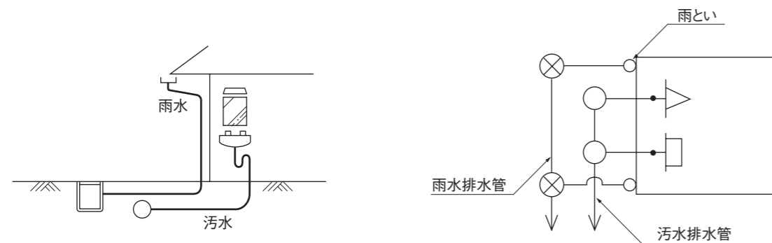
図9—10 雨水管と污水管の設置例
