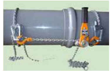
パイプ挿入機 CCBパイプジョインター(左) レバーブロック(右)
