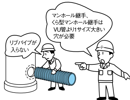
くら型マンホール継手 ゴム可とうマンホール継手 マンホール継手
